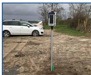
Alarme de détection des hydrocarbures autonome, équipée d'un panneau solaire KAH09
